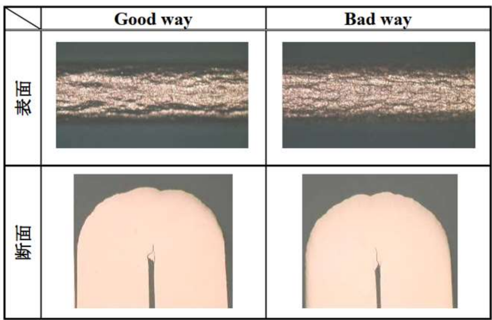
图2 紧密接触折弯测试后的折弯部表面以及断面的光学显微镜照片。 (质别 1/2H、板厚: 0.20mm、测试片宽: 10mm)。
